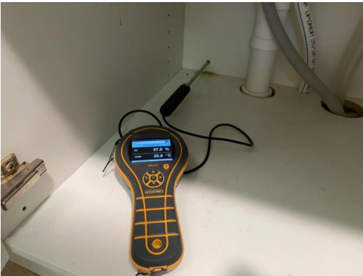
Kontroll med fuktprobe
