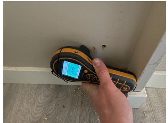
Kontroll med fuktindikator (hull til høyre i bildet fra forsøk på hulltaking)
